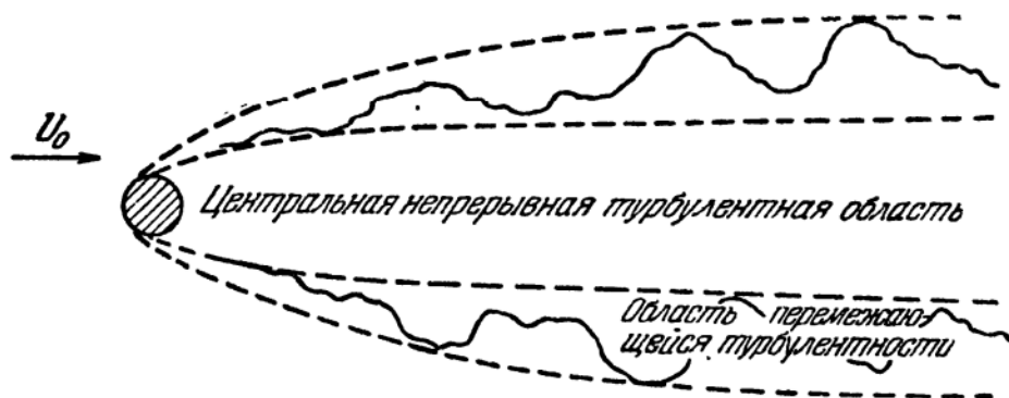
Рис. 6.11. Мгновенная картина течения в следе за цилиндром.
